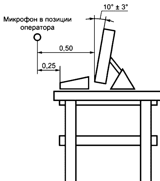
Рисунок ДА.4d - Установка оборудования типа моноблок
